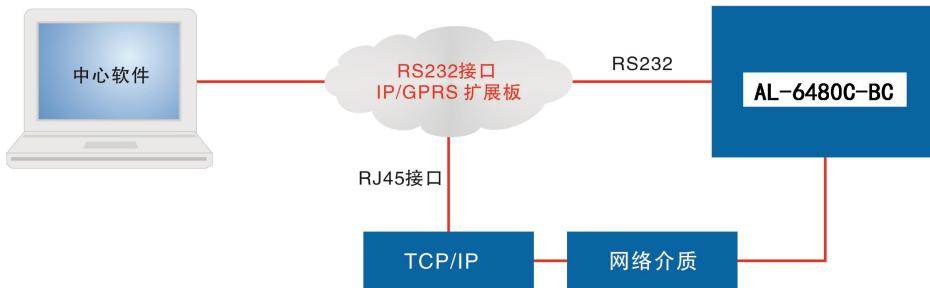
AL-6480C-BC 可以通过 IP 扩展模块与 IP 设备或主机连接，AL-6480C-BC 作为 IP 接警通讯机使用，最多可以接 128 个从设备。IP 设备、主机与 RS485 总线设备是兼容使用的，具体配置请查看“5 设备设置 - 3 设备媒介”，设为 2，为 IP 设备；设置“5 设备设置 - 4 IP 设备在线”，设置在线监测时间，单位为秒，0：表示不监测，建议设置的时间比该设备的在线上报时间多 10 秒左右。
